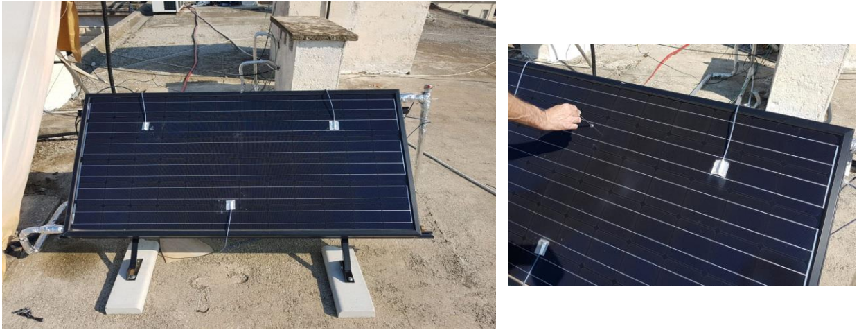
Figura 6-9: Paraqitja e Panelit PVT të instaluar së bashku me sondet e temperaturës dhe gjithë komponentet e tjere
