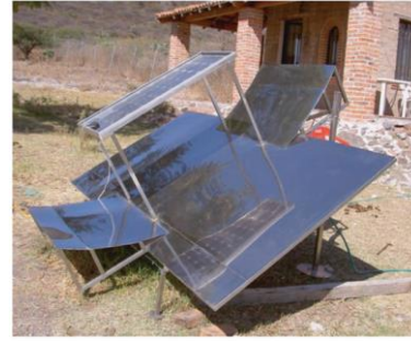
Figura 2-16: Fotografi e instalimit të sipërfaqeve reflektuese
