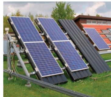
Figura 2-6 Fotografi gjatë testimit i kolektorëve të ajrit PVT
