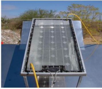
Figura 2-15: Fotografi e një sistemi hibrid (i mbushur me ujë)
